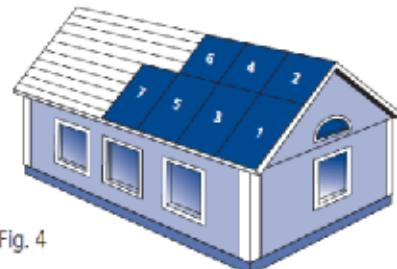
Använd nedersta bärsläkten som riktbräda vid montering av första plåten. Att första plåten kommer i rätt läge är viktigt för hela montage. Tryck upp överlappsplåtarna ordentligt mot takfallet för att undvika glipor i ändöverlappet. Kontrollera hur sista plåten kommer att ligga mot vindskivebeslaget och bestäm om det behöver klippas någon del även från den första plåten.
